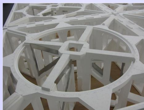
LOFAR-Antenne für Radio-Wellenlängen 4 bis 30 Meter bzw. Frequenzen 10-80 MHz (oben) und 1.25 bis 3 Meter bzw. 110-240 MHz (unten). Je 96 Antennen (oben) und 96 x 16 Antennen (unten) bilden eine Station. (© MPIfR / ASTRON)
