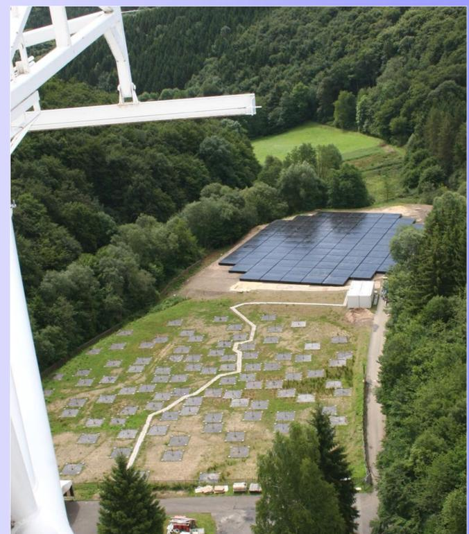
Die erste deutsche LOFAR-Station mit einer Ausdehnung von etwa 130 x 60 Metern in unmittelbarer Nähe des 100m-Radioteleskops bei Bad Münstereifel-Effelsberg. (© James M. Anderson, MPIfR)
