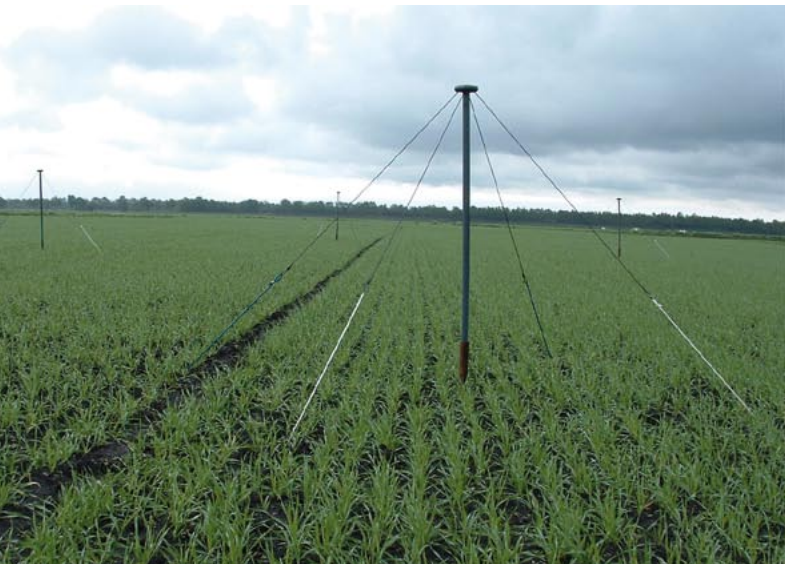
▲ Abb. 1: Die LOFAR-Antennen für die Frequenzbereiche 30–80 MHz (links) und 110–240 MHz (rechts) sind einfach aufgebaut. Je 96 Antennen beider Typen bilden eine Station (Bild: ASTRON Dwingeloo/Niederlande)
